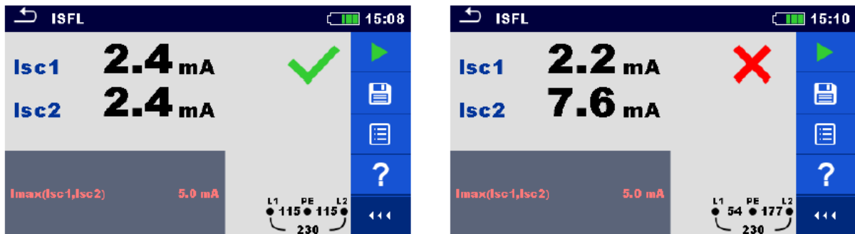
Afb. 7.113. Voorbeelden van meetresultaten van first fault lekstroom
