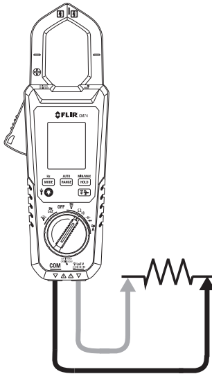
Figuur 5.5 Weerstand- en continuïteitsmetingen
