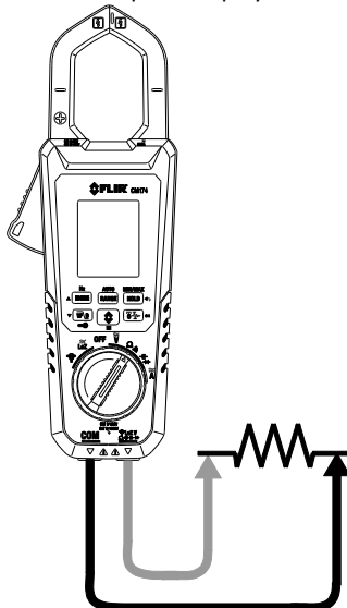
Figuur 5.5 Weerstand- en continuïteitsmetingen
