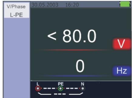
Figure 19 Ecran d'attente pour tension et fréquence
