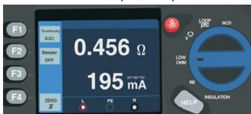
Cette fonction permet de contrôler la continuité des conducteurs de protection et des liaisons équipotentielles principales (L.E.P.) et supplémentaires, ainsi que de mesurer la résistance entre toute masse et le point le plus proche de la L.E.P. En conformité avec les normes, cette mesure s'effectue avec un courant de mesure d'au moins 200mA.
