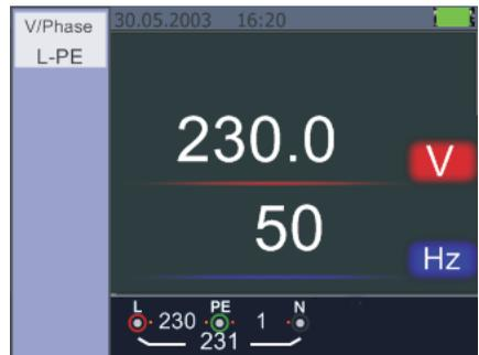
Figure 20 Ecran pendant la mesure de tension & fréquence
