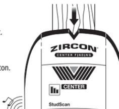
Bei tiefer in dickeren Wänden gelegenen Balken wird die Mitte des gefundenen Balkens mit nur ein oder zwei Säulen auf dem Signalstärkenanzeiger angezeigt, und nur die mittleren Segmente der Zielenzeigensäulen leuchten auf. Falls Sie danach weiterhin keinen Balken orten können, stellen Sie bitte auf DeepScan® um.
