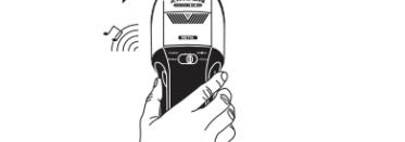
Resultate aufkommen, schalten Sie um auf den Metal Scan Modus um Nägel oder Schrauben zu lokalisieren, die am Balken oder der Metallverstrebung vertikal angebracht wurden.
