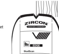
Fahren Sie entlang der Oberfläche mit dem Scannen fort. Wenn die Balkenmitte ermittelt wurde, leuchten die drei Säulen auf dem Signalstärkenanzeiger, die mittleren Segmente der Zielenzeigensäulen, die MITTE-Anzeige sowie der SpotLite®-Zeiger auf, und es ertönt ein Signalton.
