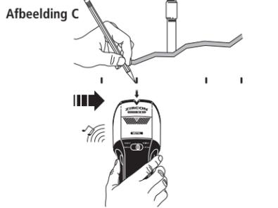
Als het werktuig aangeeft dat een grote oppervlakte metaal bevat, kunt u het scanningsgebied specifieker maken om nauwkeuriger te bepalen waar het metaaldoel zich bevindt door Stappen 3 en 4 te volgen.
