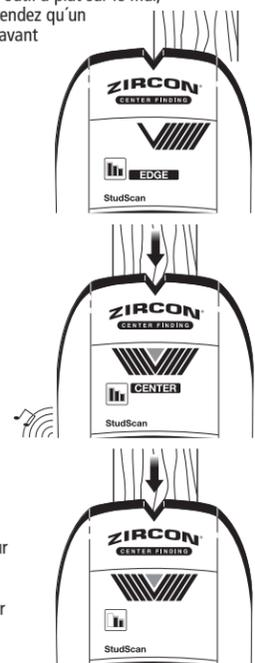
Continuez à faire glisser l'outil. Lorsque le centre d'un objet est détecté, les trois barres sur l'Indicateur de Puissance du Signal, les segments de l'Indicateur de Cible, l'indication CENTER et le Pointeur SpotLite® s'allument tous et le buzzer se fait entendre.
