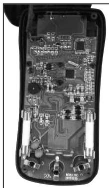
Ubicación de los fusibles cilíndricos blancos del medidor
