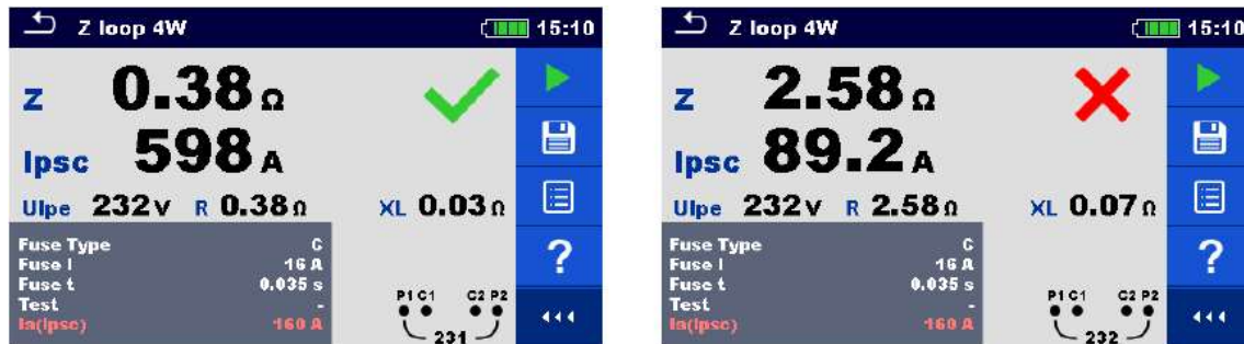
Afbeelding 7.45. Voorbeelden van Z lus 4W metingen
