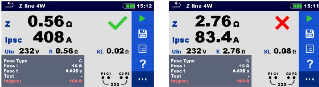
Afb. 7.59. Voorbeelden van resultaten van Z line 4W metingen
