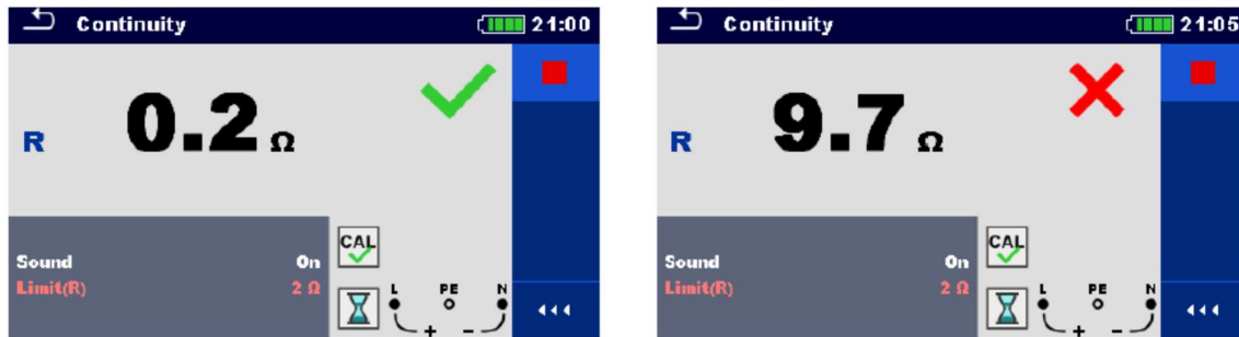
Afbeelding 7.29. Voorbeelden van resultaten van meting van continuïteitsweerstand
