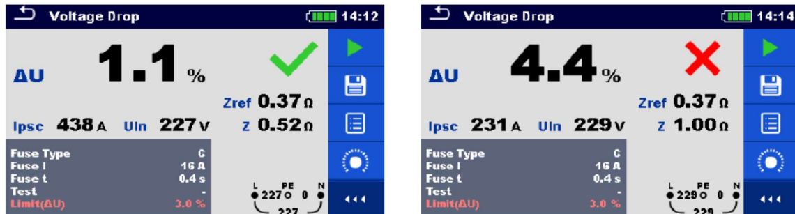
Afbeelding 7.69. Voorbeelden van het resultaat van meting van spanningsval (Stap 2)
