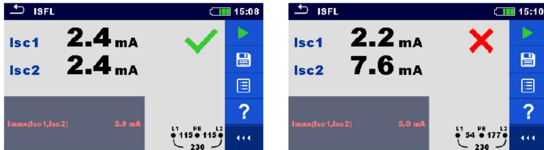
Afb. 7.113. Voorbeelden van meetresultaten van first fault lekstroom
