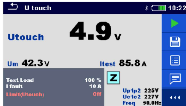
Afbeelding 7.72. Voorbeeld van het resultaat van meting van contactspanning
