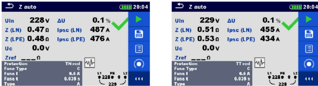
Afbeelding 7.75. Voorbeelden van resultaten van Z auto meting
