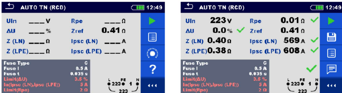
Afb. 7.132. Voorbeelden van resultaten van AUTO TN (RCD) meting.
