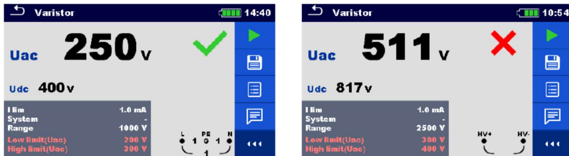
Afbeelding 7.20. Voorbeelden van resultaten van varistortest
