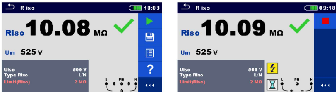
Afbeelding 6.1. Schermorganisatie individuele test, voorbeeld van isolatieweerstandsmeting
