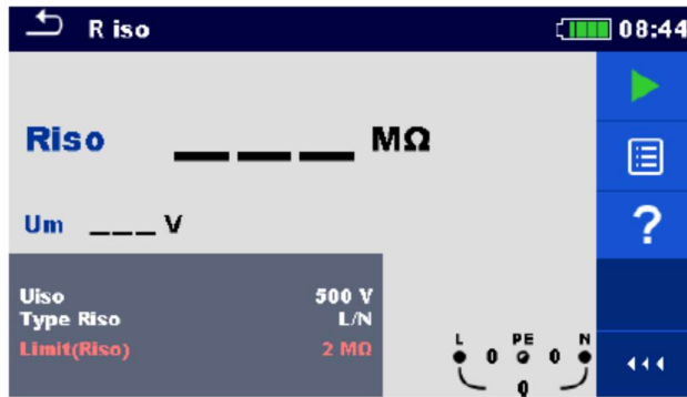
Afbeelding 6.2. Start scherm individuele test, voorbeeld van isolatieweerstandsmeting
