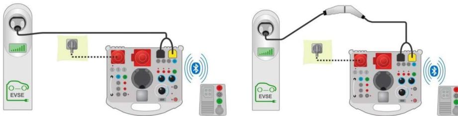
Figure 5.7 : Test de diagnostic – connexion de test de simulateur VE vers EAVE mode 3
