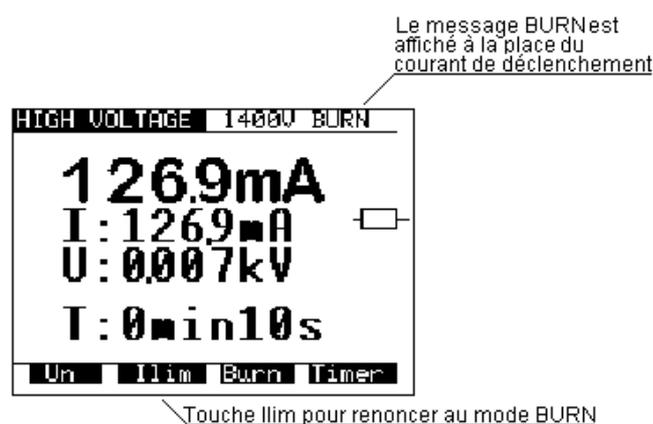
**Fig. 8. Menu principal en fonction HV (haute tension) lorsque le mode Burn (court-circuit) est sélectionné**
