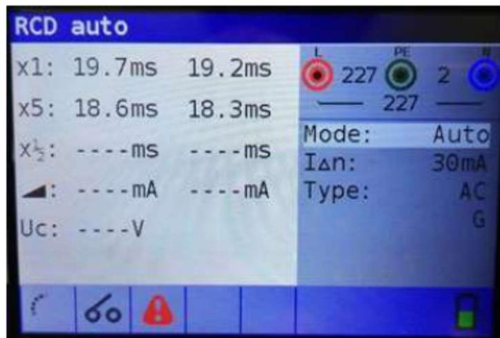
Figure 5-23: Étape 4 DDR (RCD) résultats de test automatique
