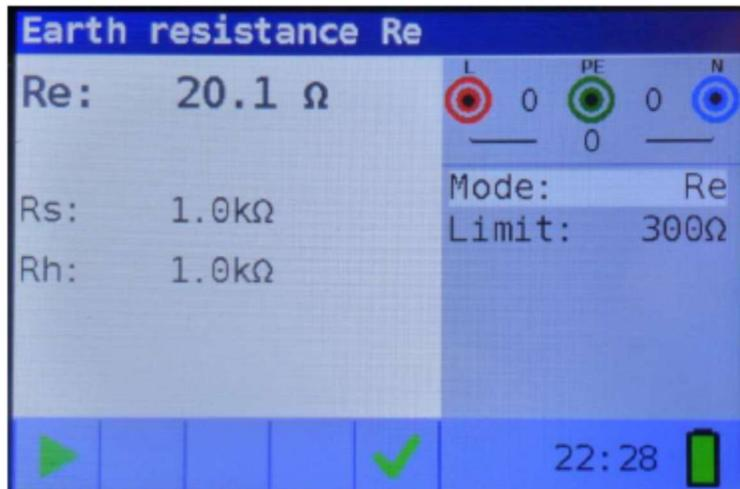
Figure 5-46: Exemple de résultats de mesure résistance terre
