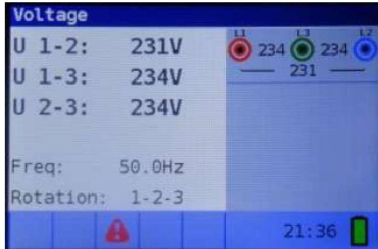
Figure 5-38: Exemple de résultat d'un test de séquence de phases
