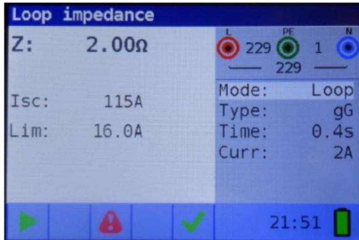
Figure 5-30: Exemple des résultats de mesure d'impédance en boucle
