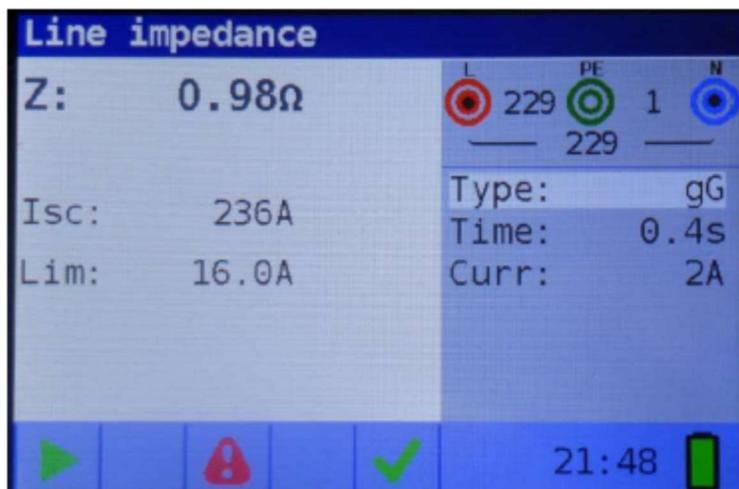
Figure 5-35: Exemple des résultats de mesure d'une impédance en ligne
