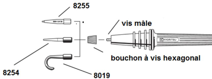
Tournez la sonde ligne dans le sens anti-horaire pour enlever la pointe de touche métallique. Insérez la pointe de touche à utiliser dans le bouchon à vis hexagonal et tournez-la dans le sens horaire. Serrez les vis.
