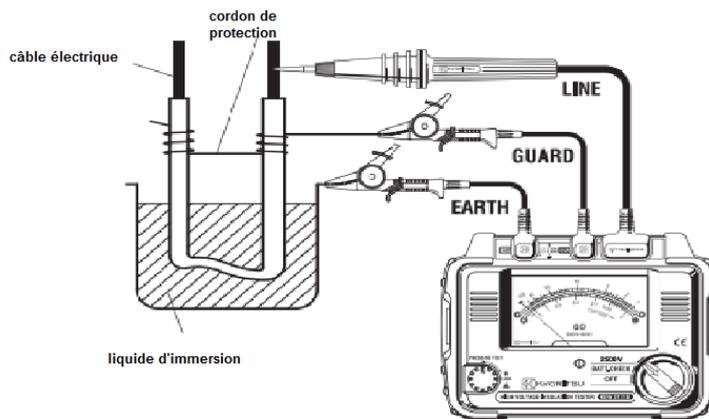
\* Il est possible d'éliminer la résistance de fuite superficielle de l'isolément et de mesurer uniquement la résistance de volume de l'isolateur. C'est pratique en cas de mesures dans des environnements humides.
