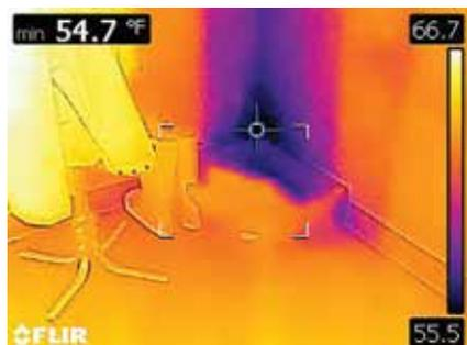
La zone délimitée d'un point froid montre les infiltrations d'air
