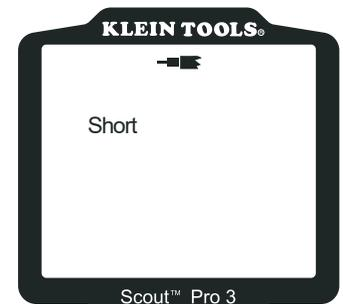
**Koaxialkabel mit Kurzschluss:** Der Innenleiter des Kabels ist mit dem Schirm verbunden. Dies erzeugt einen Kurzschluss. Der Kabeltest schlägt fehl und die Nummer der Remote-Ortungseinheit am anderen Kabelende kann nicht bestimmt werden.
