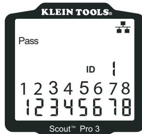
**Korrekt verdrahtetes UTP-Kabel (T568A):** T568B ist elektrisch identisch mit T568A, allerdings sind die grünen und orangefarbenen Adernpaare vertauscht. Beide Standards funktionieren, solange an beiden Enden einer Kabelführung oder eines Patchkabels der gleiche Standard verwendet wird. Beim Kombinieren der Standards „A“ und „B“ erhalten Sie ein Crossover-Kabel.
