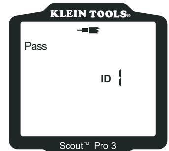
**Korrekt verdrahtetes Koaxialkabel mit Remote-Ortungseinheit Nr. 1:** Die Remote-Ortungseinheit Nr. 1 wird zum Abschluss eines korrekt verdrahteten Koaxialkabels verwendet. Die Videoprüfung ist erfolgreich, die ID-Nr. 1 wird erkannt.
