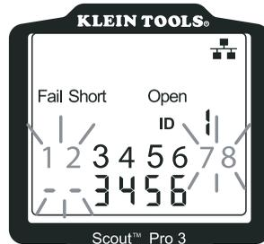
**T568A-Kabel mit einem Kurzschluss und einer Unterbrechung (offene Stelle):** Die Stifte des Adernpaares 1-2 sind kurzgeschlossen und im Adernpaar 7-8 befindet sich eine offene Stelle. Die zugehörigen Stifte zu den Fehlern werden blinkend angezeigt. Die Striche in der untersten Display-Zeile (Remote-Zeile) zeigen den Kurzschluss und die fehlenden Nummern in dieser Zeile zeigen das Adernpaar mit Unterbrechung an.
