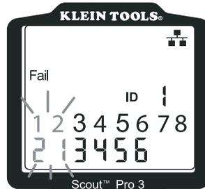
**T568A-Kabel mit einem Verdrahtungsfehler und unerkanntem Durchgang:** Die Kontaktstifte 1 und 2 am Prüfgerät Scout® Pro 3 sind mit den Stiften 2 und 1 an der Remote-Einheit verbunden. Die zugehörigen Stifte zu diesem Fehler werden blinkend angezeigt. Das „U“ für die Stiftnummern der Remote-Einheit zeigt an, dass kein Durchgang festgestellt werden konnte, ohne dass ein Kurzschluss oder eine offene Stelle vorliegt.
