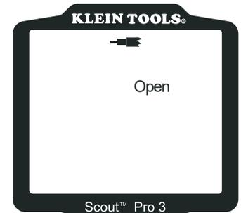
**Koaxialkabel mit Unterbrechung:** Der Kabeldurchgang ist unterbrochen. Eine Unterbrechung im Schirm oder im Innenleiter kann zu einem „open“-Fehler führen. Der Kabeltest schlägt fehl und die Nummer der Remote-Ortungseinheit am anderen Kabelende kann nicht bestimmt werden.
