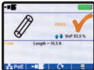
Meet de lengte van de kabels en de afstand tot een fout met de Time Domain Reflectometry (TDR) technologie
