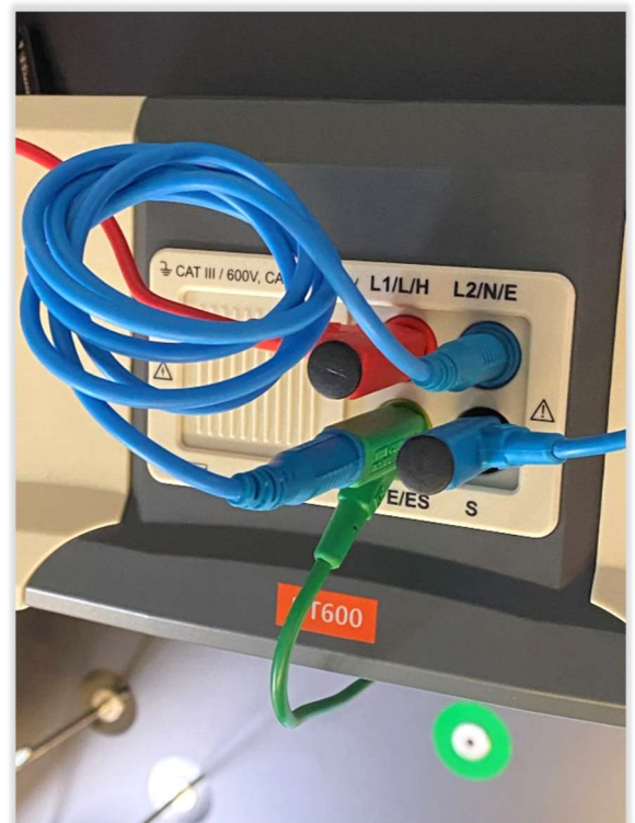
Figuur 3: aansluiting op het toestel
