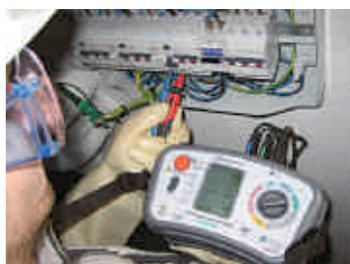
L'instrument est pourvu d'un bouton de test sur la sonde et d'un bouton de test avec dispositif de verrouillage pour un test mains-libres.
