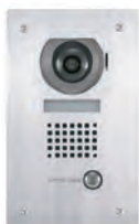
AXDVF Vandalismebestendige video-deurpost, inbouw (voor inbouw in zuil): PA1601 + PAX te voorzien (146 x 246 x 2 mm) Inbouwdoos: (114 x 214 x 45 mm)
